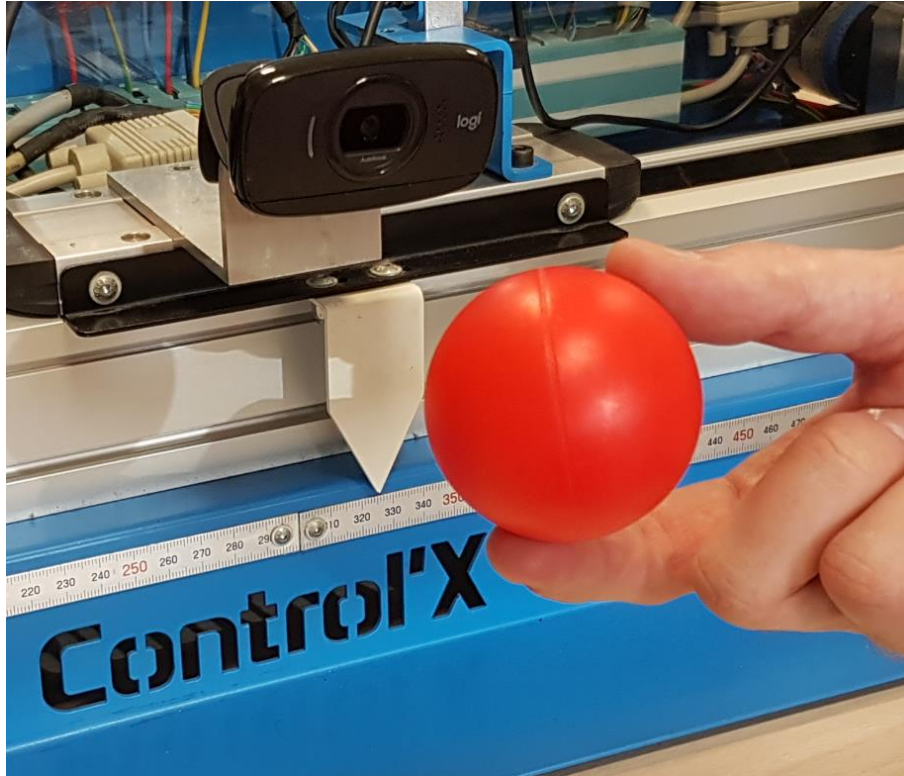
Suivi de cible par analyse d'image sous Simulink
