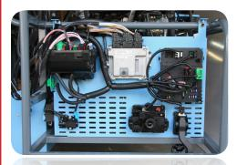
Les bancs didactisés sont composés de l'ensemble des constituants nécéssaires au fonctionnement de la gestion moteur et sont regroupés sur une platine support facilitant l'identification des composants.
