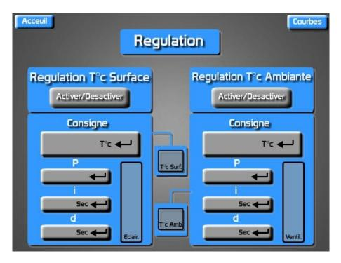
Il est possible d'effectuer une double régulation de température. Une régulation de température de surface des panneaux solaire et une régulation de température de l'Air Ambiante. Un Accès à un affichage de courbes est possible.
