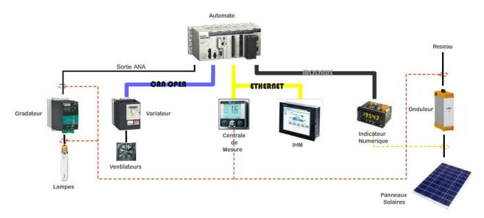
L'architecture du Système Permet de réaliser des mesure physiques en différents points, en Amont du gradateur, en Aval du Gradateur, en Amont de l'onduleur et aux bornes des Panneaux Solaires.
