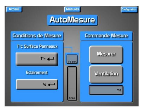
Le mode AutoMesure permet d'automatiser une mesure, choisissez la temperature de surface du panneau à laquelle vous voulez effectuer cette mesure, l'intensité d'éclairement. Le système atteint votre choix de consigne puis débute la mesure.
