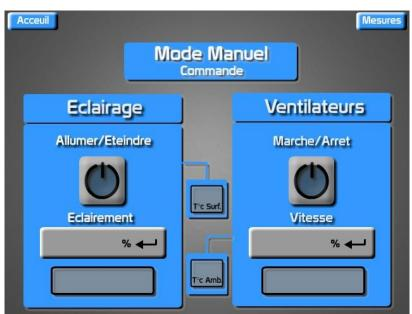
Le mode Manuel permet le contrôle de l'éclairage ainsi que de la ventilation avec leur consigne respective. La lecture des températures de surface et Ambiante. Un accès aux pages de mesure est aussi possible.
