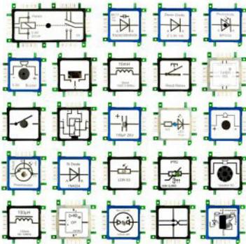
Le pack avancé se compose de 111 briques et permet la création de circuits avancés. Le système de d'apprentissage innovant Brick'R' permet d'appréhender de manière ludique l'électronique en découvrant les composants de bases (résistances, capacités, diodes...), les portes logiques (ET,OU, NONET...) ainsi que des composants plus complexes (Transistors, ampli OP, Timer NE555,...).
